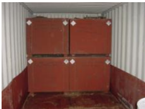
EMBALAJE DE BIFENILOS POLICLORADOS SÓLIDOS CLASE ONU 9, NÚMERO ONU 3432
