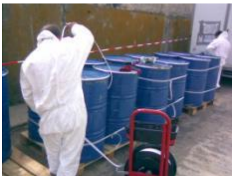
PREPARACIÓN DE EMPAQUE LLENOS CON CLASE ONU 6.1 SÓLIDOS (UN2588)
