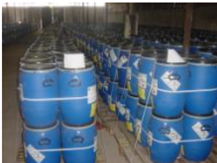
ALMACENAMIENTO ADECUADO DE RESIDUOS CLASE ONU 6.1 (UN2588)
