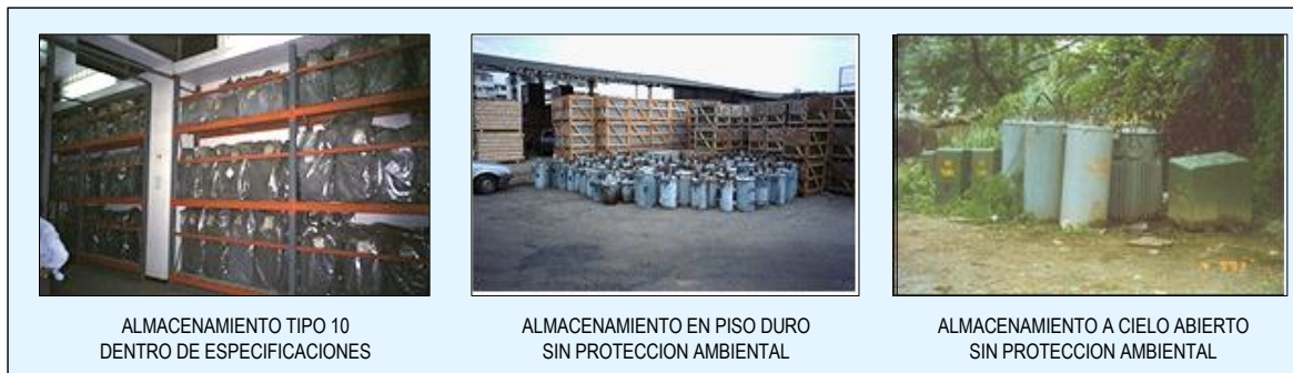
CUADRO 14: EJEMPLOS DE ALMACENAMIENTO CORRECTO E INCORRECTO DE RESIDUOS
