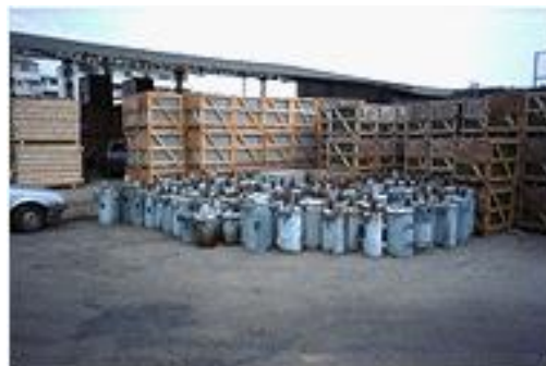
ALMACENAMIENTO INADECUADO DE RESIDUOS CLASE ONU 9 (3432)
